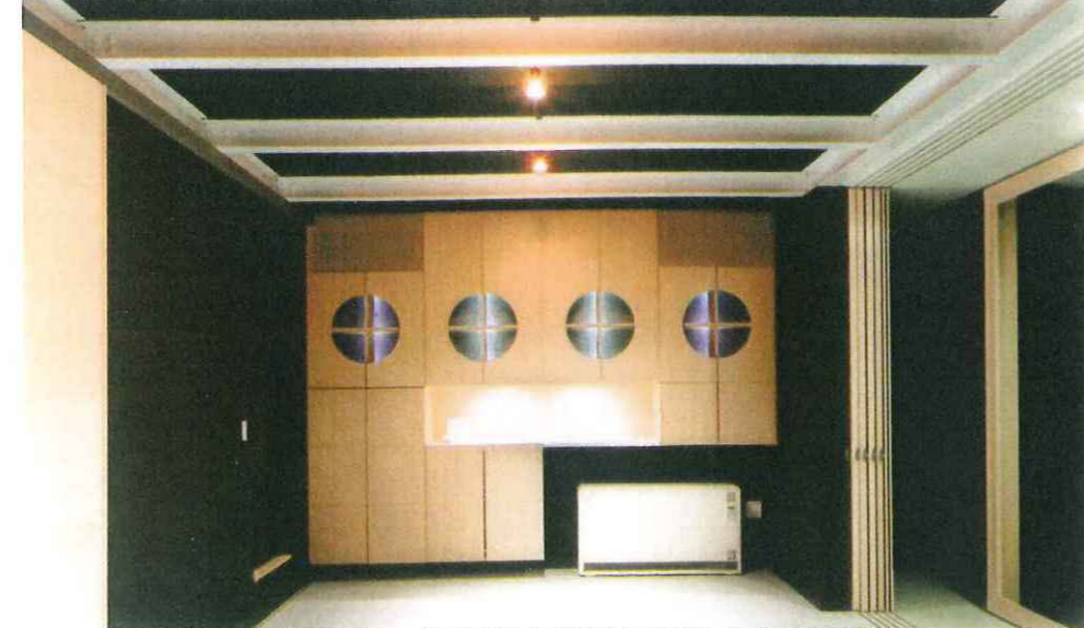
...1階応接室夜景...深夜電力利用の蓄熱式暖房機で暖房...
