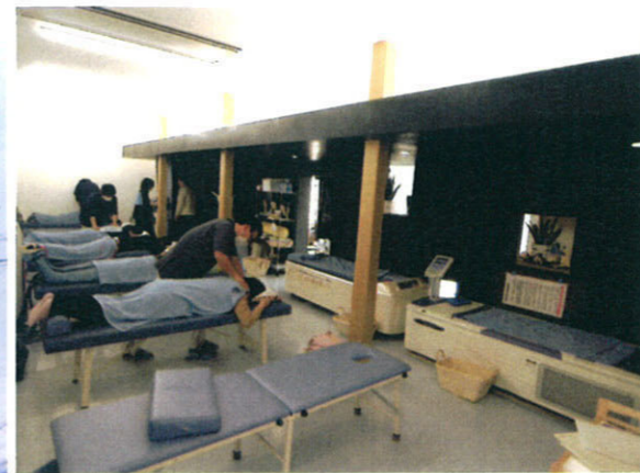
⑦1F（接骨院）施術室：間仕切り壁の上部を開放し、1ルーム化することで、患者とスタッフの距離を縮め、冷暖房費を節約する
